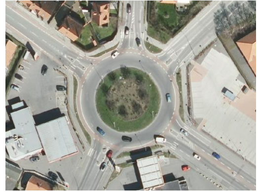
Figur 2. Eksempel på rundkørsel med farvet cykelbane i cirkulationsarealet. Denne løsning kan ikke anbefales (Google Maps).
