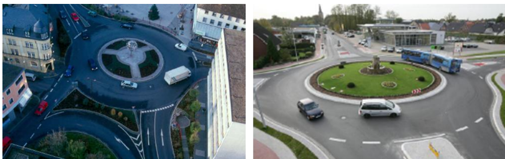
Figur 16. To eksempler på kompakte 2-sporede rundkørsler i Tyskland (Brilon, 2005).
