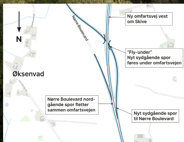
Visualisering: Den nye omfartsvej mødes med den eksisterende Rute 26 nord for Skive. Der etableres en "fly-under" for trafik, der vil forsatte på den gamle vej mod Skive. Billedet er set fra nord mod syd.
